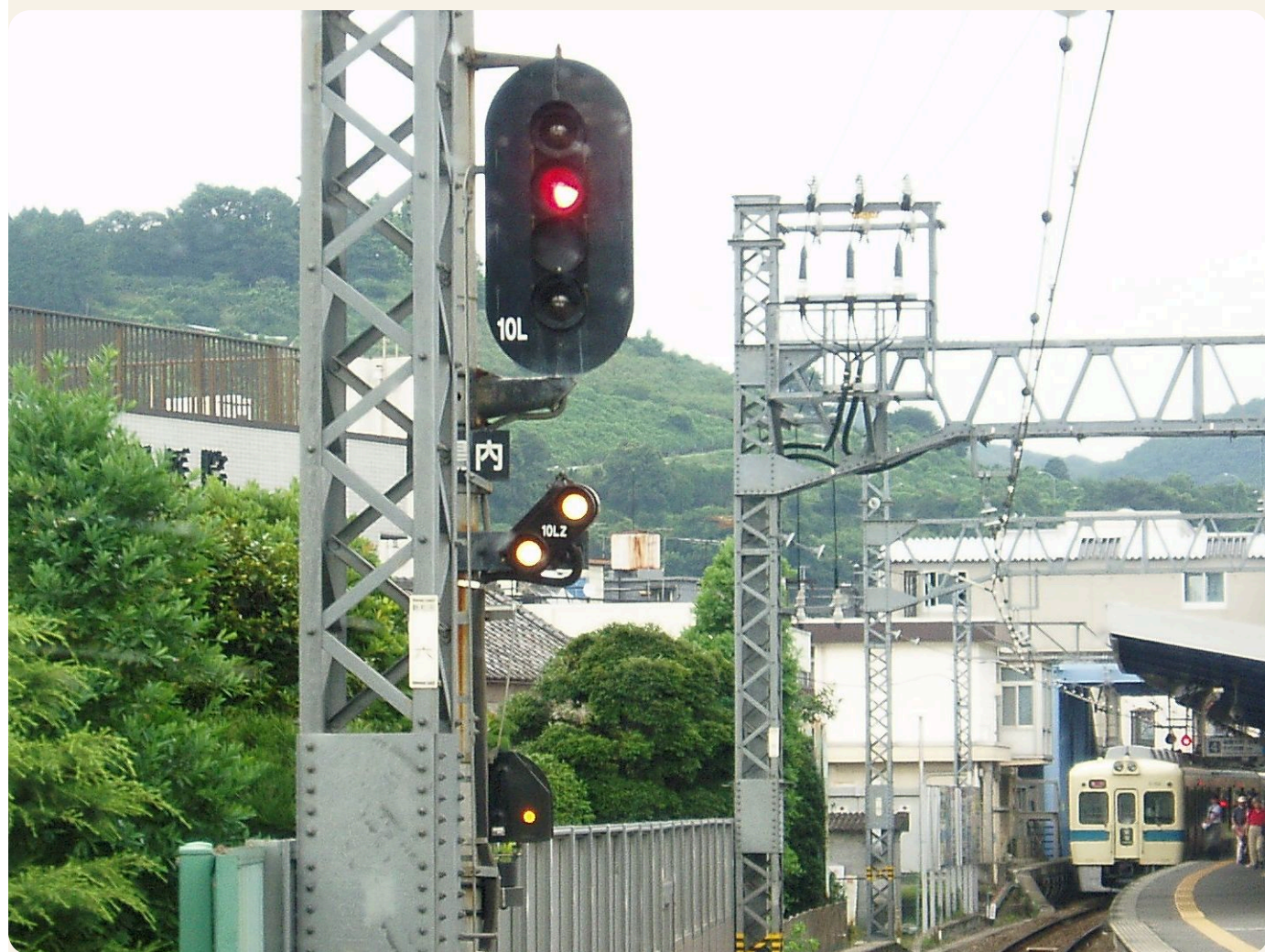
诱导信号机实物（小田急新松田站）：主信号（10L）亮着红灯，下方两盏白灯斜 45 度点亮（10L2）——「前面有车，以步行速度爬进去」的例外许可。图：Cassiopeia sweet / 公有领域 / Wikimedia Commons
