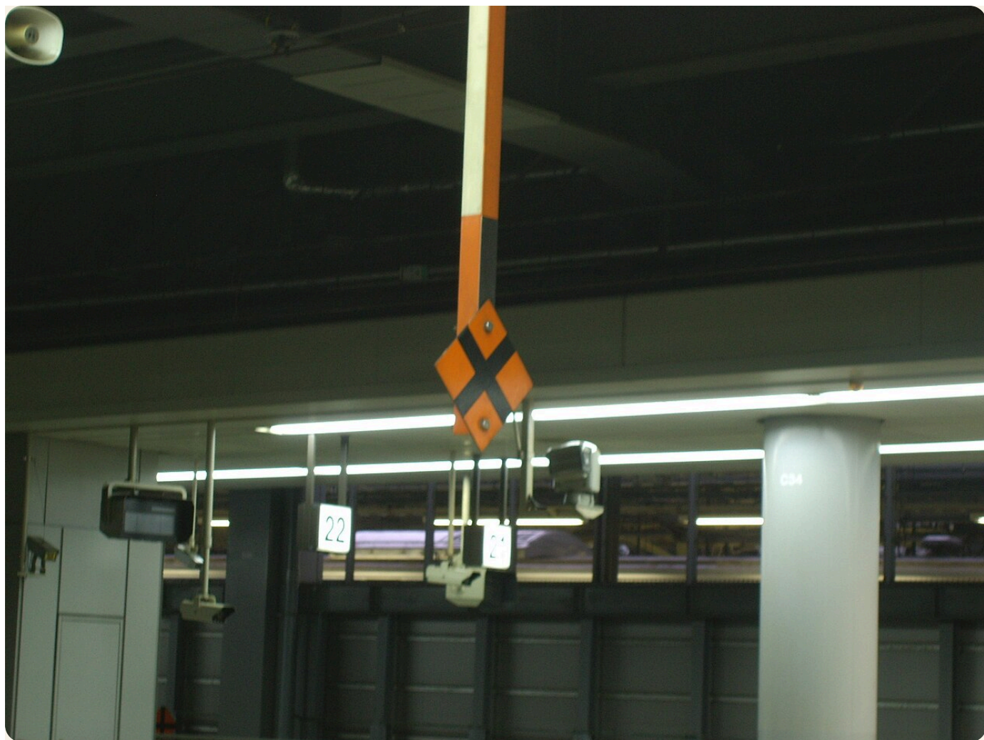
新干线站台的停车目标标：橙黑标记吊在司机视线的高度，进站时司机的全部注意力就锁在它上面（品川站）。图：電車（新幹線）でゴー！ / CC BY-SA 4.0 / Wikimedia Commons
