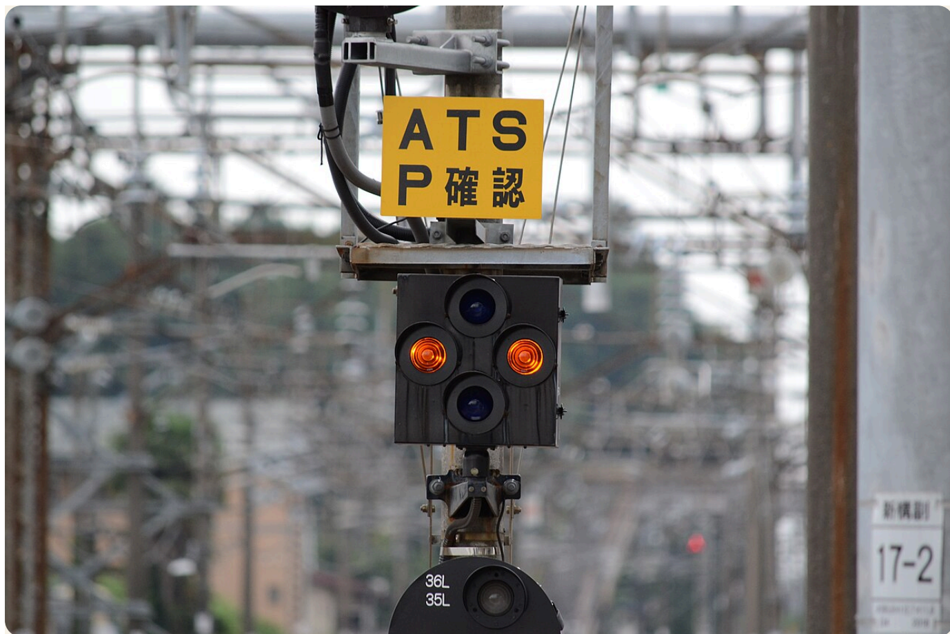
架线电源识别标识实物（东北本线黑矶站）：两盏灯点亮，表示到这台信号机为止的接触网已加压为交流 20kV · 50Hz——再往南就是直流 1500V 的王国。黑矶正是日本最著名的交直分界。图：Toshinori baba / CC BY-SA 4.0 / Wikimedia Commons
