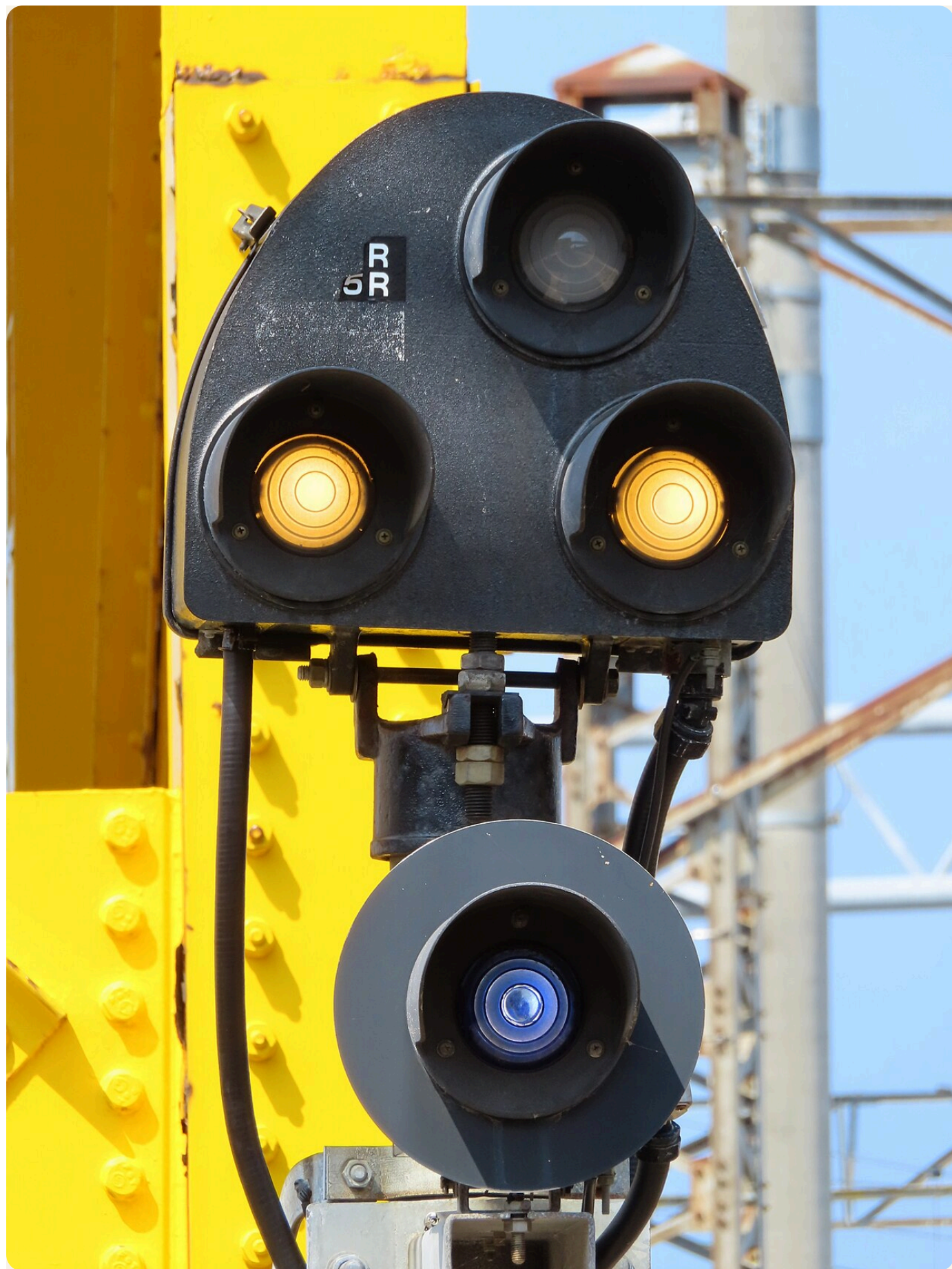
入换信号机实物（青森站）：两盏月白灯 水平 点亮＝调车停止；转成斜 45 度才是放行。黑色小机身、月白灯色，处处都在说「我和行车信号不是一家」。图：運動会プロテインパワー / CC BY-SA 4.0 / Wikimedia Commons
