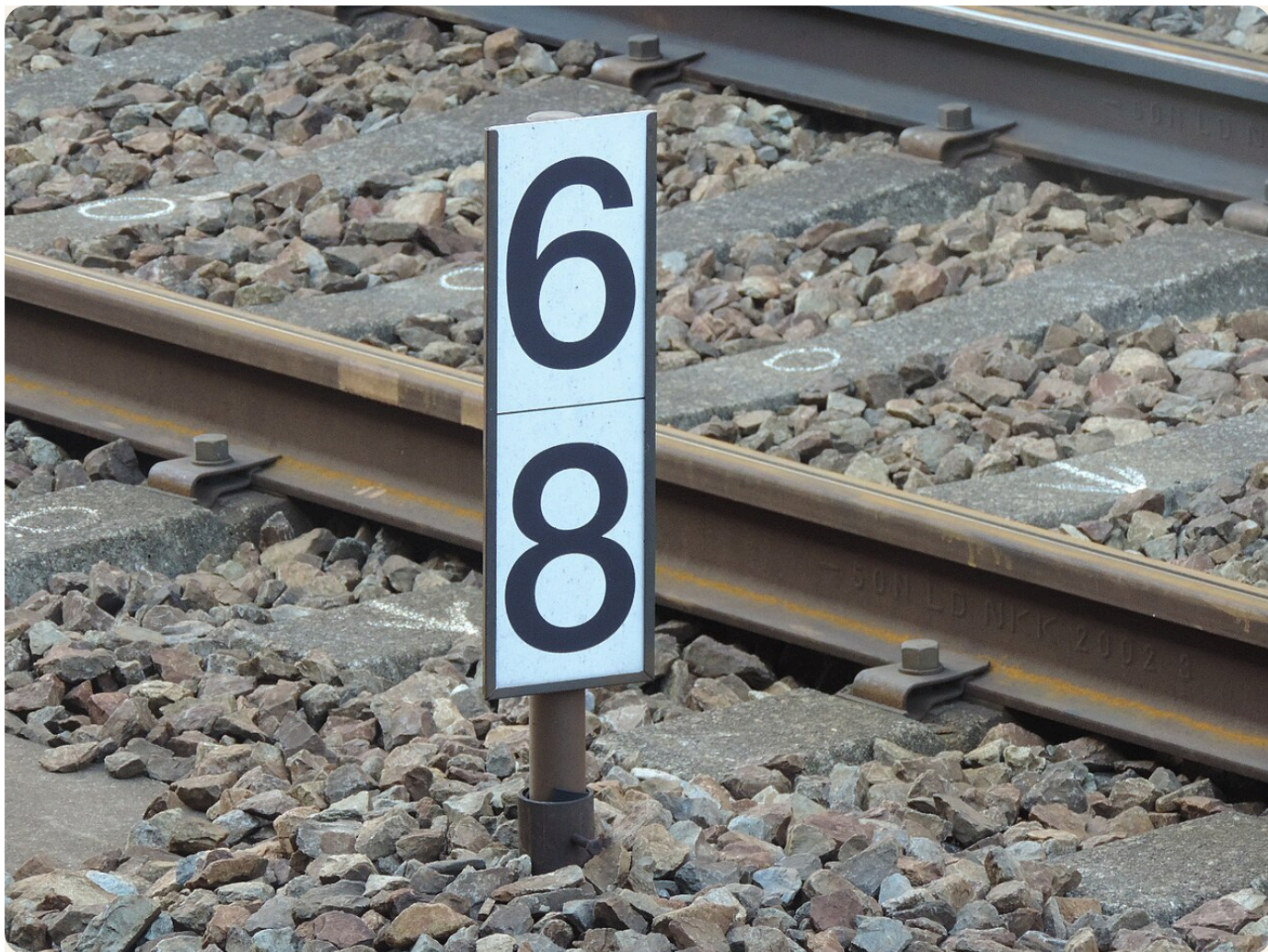
停车位置标实物：「6」「8」表示 6 辆、8 辆编组的列车停在这里（阪急冢口站）。图：運動会プロテインパワー / CC BY-SA 4.0 / Wikimedia Commons
