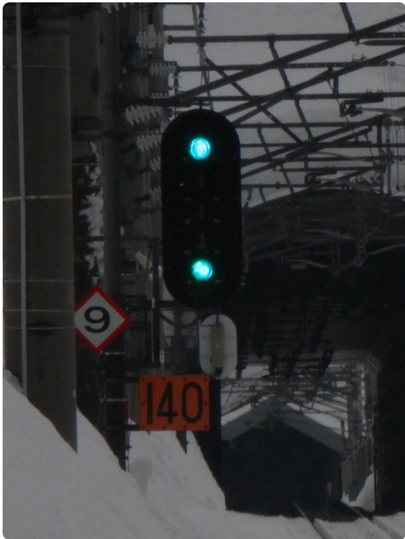
六级阶梯的最顶一级实物：两个绿灯上下排列的「高速進行」（北北线松代站，下方橙色牌是配套的 140 速度标）。图： Cassiopeia sweet / 公有领域 / Wikimedia Commons
