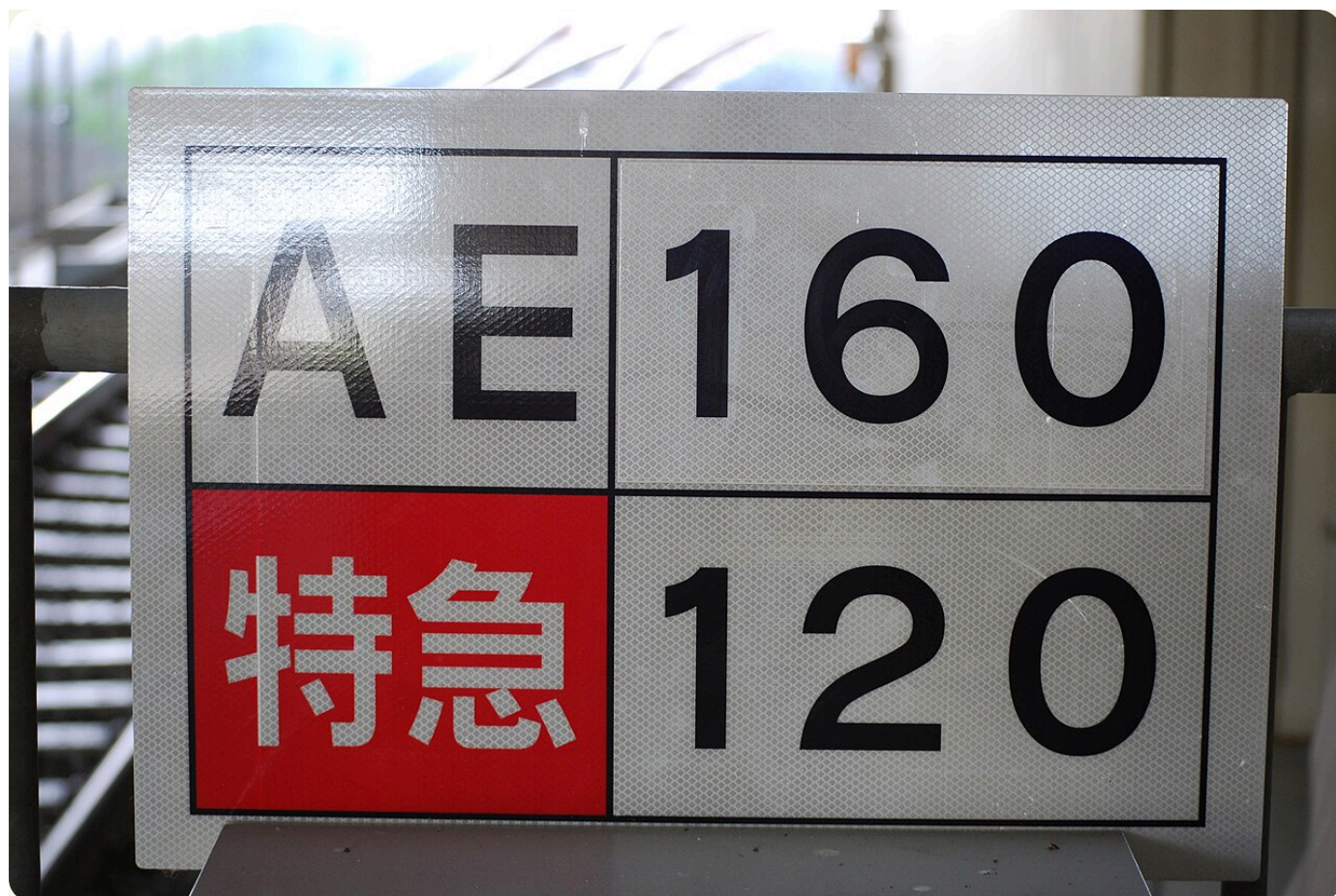
种别速度标识实物（京成・印旛日本医大站）：同一块牌子上，AE 型（Skyliner）160、其他特急 120——线路的物理极限没变，变的是车，所以限速按车分档。图：toshinori baba / 公有领域 / Wikimedia Commons
